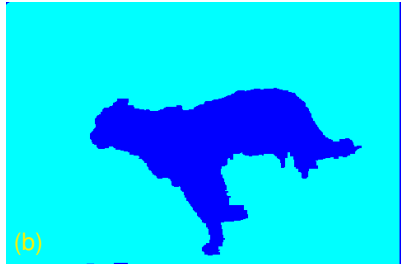
Şekil 7: Çita imgesine ait (a) filtrelenmiş imge, (b) bölütlenmiş imge
